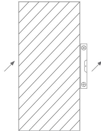
Plaats tegen de wand en druk aan. Herhaal stap 1 en 2 voor de rest van de panelen.
